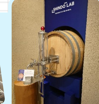
特注で製作したハンドフィル機。
